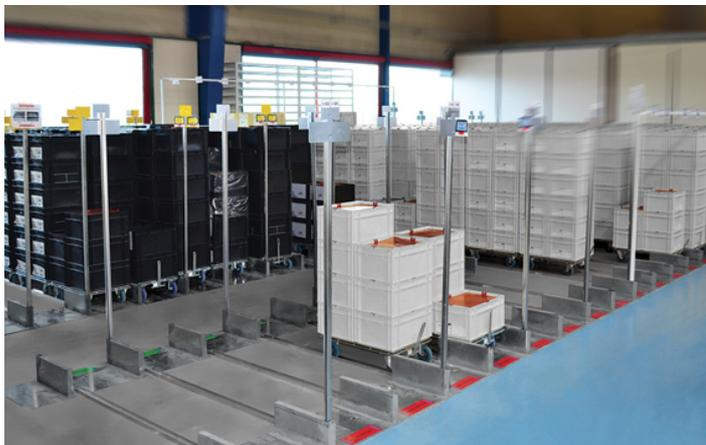
Nos gares facilitent la mise à disposition des encours et le pilotage de l'atelier de façon visuelle et structurée. Il s'agit d'obtenir une vue globale des pièces et des composants disponibles afin d'apprécier et de contrôler les manquants et les surstocks. EUROPE METAL FIL vous propose différents modèles de gares, au sol et aérien, avec guidage et affichage compatibles avec l'ensemble de nos rollers, embases, chariots, dollies, etc.
